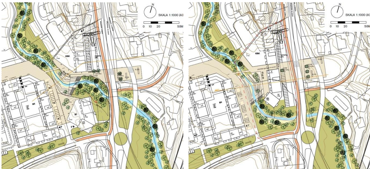
Figur 1: Alternativer for nytt nærsenter på Billingstaf vest. Venstre: Langs Neselva (opprettholder eksisterende elveløp). Høyre: Portalbygget (omlegging av elveløp). Tegninger fra White arkitekter 24.02.2016.
