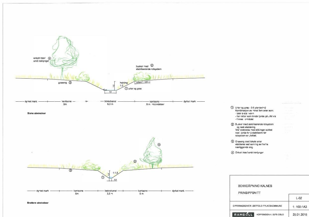
Figur 13. Prinsippsnitt for partier med slakere helling (øverst) og brattere helling (nederst). Skisser i opprinnelig skala fins i Vedlegg 2.
