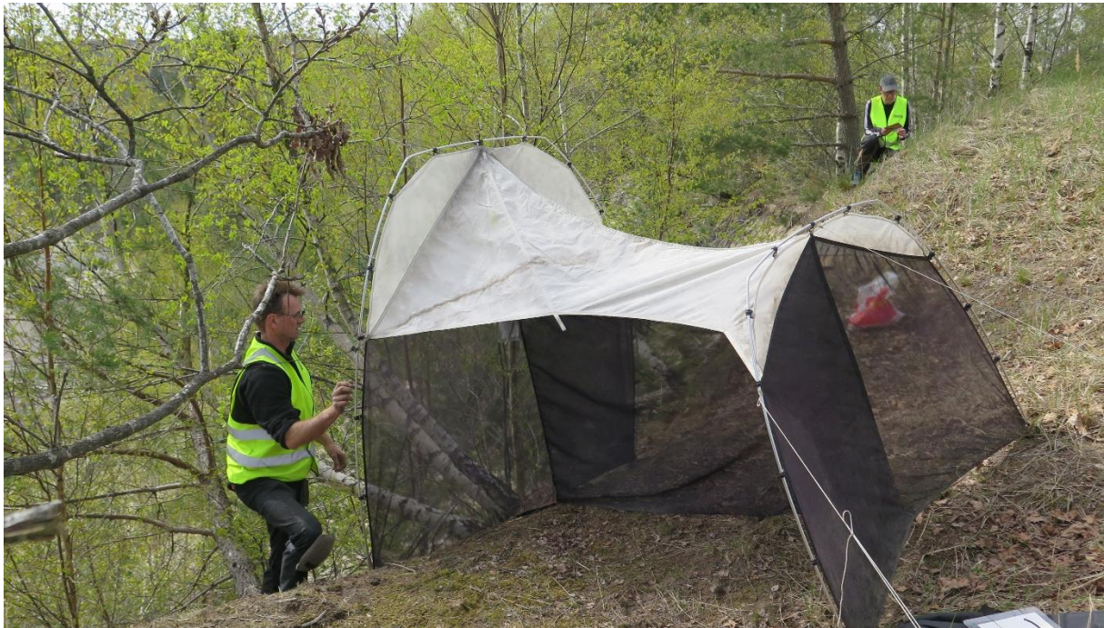
Figur 5: Montering av malaisefelle ved Bugten. Konstruksjonen er et slags telt der insektene søker til det høyeste punktet, hvor de etter ned i en beholder med konserveringsvæske. Fellen monteres slik at det høyeste punktet med beholderen vender mot sør-sørvest. Malaisefeller samler bredt mange grupper insekter. Foto: Ole J. Lønnve.
