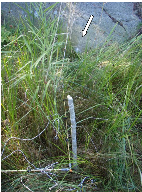
Rute II. Merkepinne i sørøsthjørnet til venstre, innhugget kryss i berget til høyre (pil).
