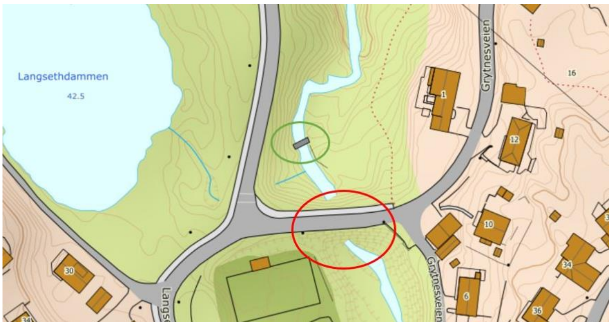
Figur 18: Grønn sirkel er en gammel demning/terskel etter tidligere tiders virksomhet, mens rød er undergangen ved Grytnesveien der bekken går gjennom en kulvert/rør. Ved begge disse punktene kan ikke fisk forsere.
