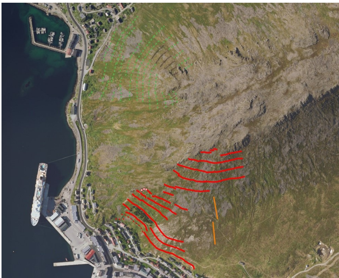
Figur 2: Tidlig skisse over planlagte skredsikringstiltak.
